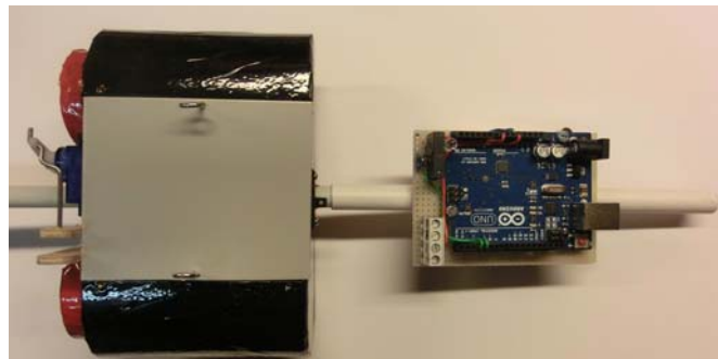
Figur 3.7 Termineringselektronikken montert sammen med slippmekanismen.
