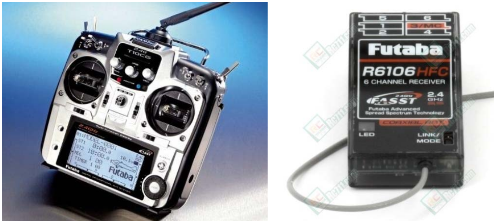
Figur 3.2 Fjernstyringsenheten FutabaT10CAG 10 kanals sender og en F6106 HFC 6 kanals mottaker fra samme firma.
