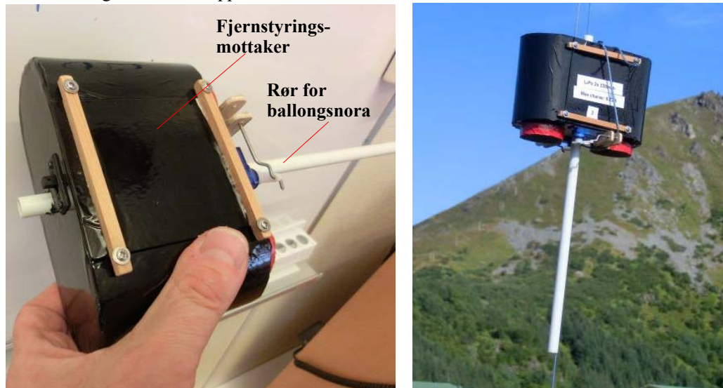
Figur 3.1 Fjernstyrt slippmekanisme for to CanSat'er
